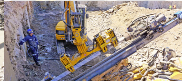
Manipolatore per aste e rivestimenti CPH CPH rod and casing handling unit
